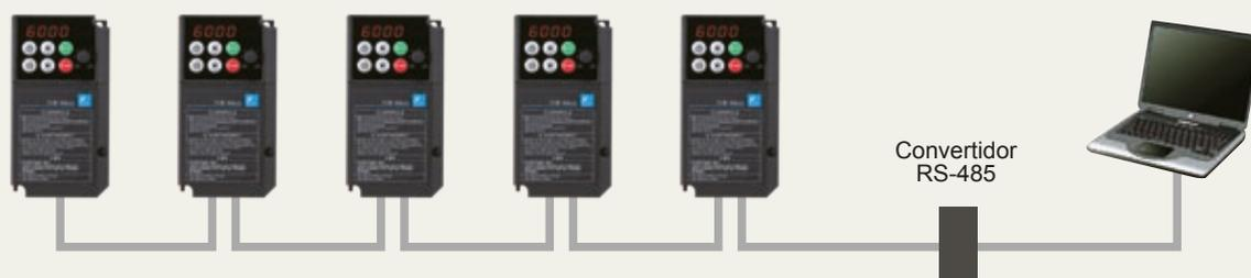
La conexión multipunto es posible en terminales compatibles con comunicación Modbus
