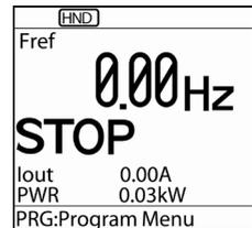
Figura 4.2 Vista de la pantalla de LCD tras el encendido
